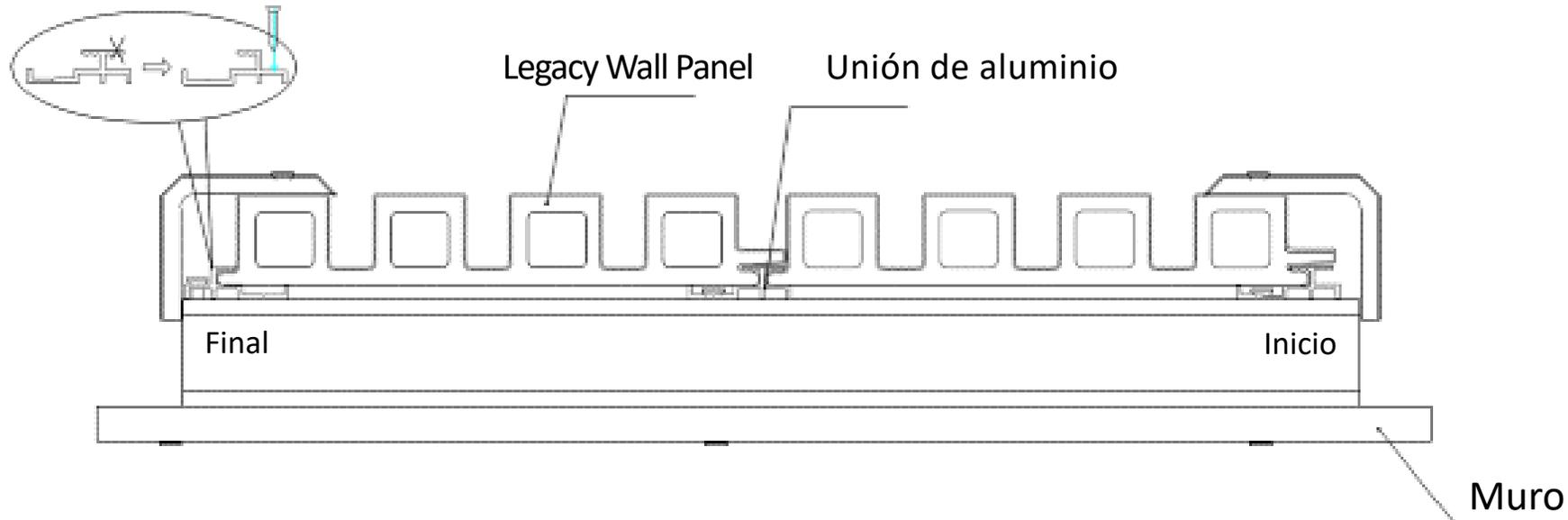
Corte el clip de aluminio como se muestra en la imagen, luego taladre un agujero y atorníllelo. Comparado con la forma 1, menos parte del clip de aluminio quedara expuesta de esta manera, para que el efecto de instalación se vea más estético.
