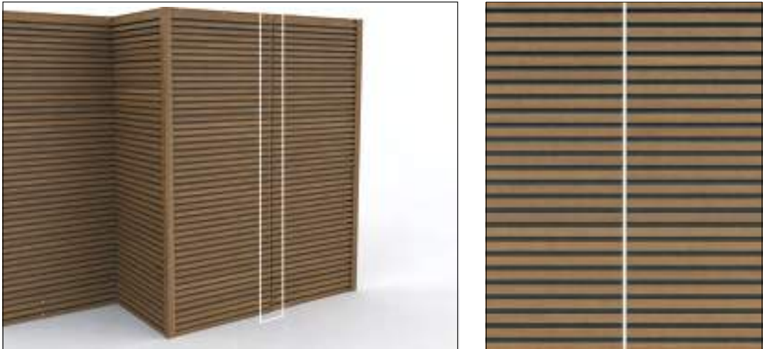
|| Deje un espacio de 5 mm entre los extremos de dos paneles de pared
